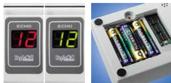
受信機に信号が届くとLEDの表示が赤から緑に変化します。
